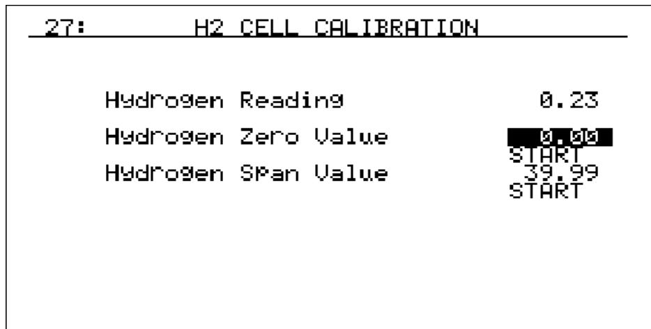
校验零点值，关闭取样泵，按照 1.5 ~ 2.0 SCFH 的流量通入调零气体，最合适的调零气体为氮气或者氩气或者其他惰性气体。持续通入气体直到读数稳定为止，此过程需要一到两分钟。输入目标值（此值应该为 0）使用向下键选中 Start 然后按 enter，在零点校准完成以后，仪表目前的氢读数应该等于 0.
