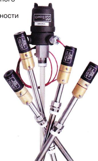
**Датчик GOLDPRODE** – циркониевый датчик кислорода, используемый для измерения углеродного потенциала или точки росы в безокислительной, восстановительной, нейтральной или цементационной среде.
