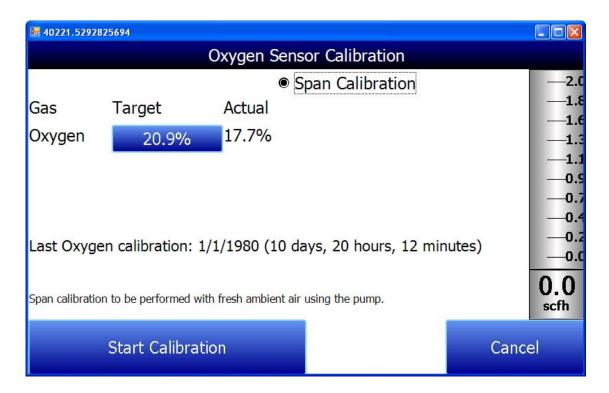
산소 센서 교정할 때 보여지는 화면이며, 교정을 시작하면 자동적으로 펌프는 on 이 됩니다. 실제 값과 평행을 이루게 되면 Start 버튼을 눌러서 교정을 시작하면 됩니다. 이 경우에 측정값과 설정 값이 동일해 지는 것을 볼 수 있습니다..
