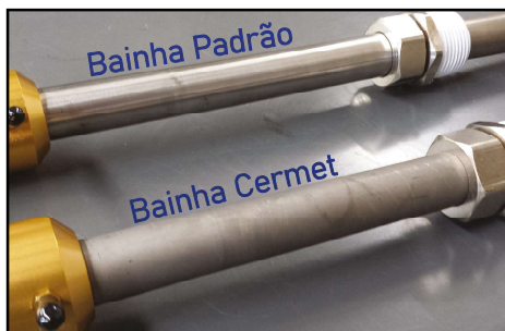
A Bainha de "Cermet" acrescenta a CeraGold uma camada protetora, impenetrável e resistente ao calor. A imagem acima mostra aspecto brilhante da bainha padrão e a superfície opaca e rugosa da bainha "Cermet".
